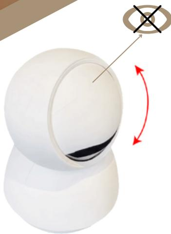
Dès la mise en service de l'alarme, l'objectif sort de sa cachette. La caméra est accessible.
